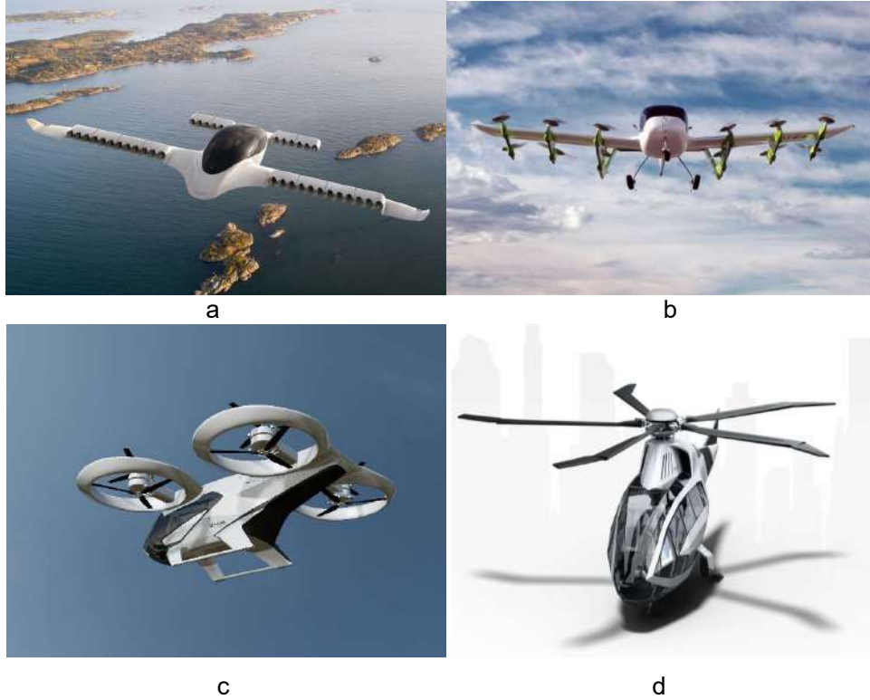
Şekil 6 İHA Konfigürasyonları (a-Vektörlü İtki, b- Lift-Cruise, c- Multirotor, d- Helikopter)
